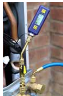
El «conector hembra abocardado con ángulo de 45 grados» se conecta directamente al sistema para permitir una lectura más precisa.
