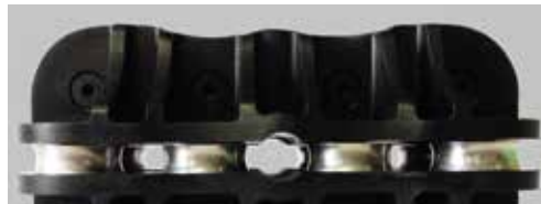
Orificio central enderezadora de tubos
